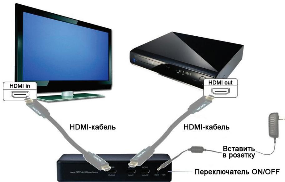
1. Подсоедините штекер на кабеле зарядного устройства к разъему питания на задней панели корпуса 3D-конвертера. Вставьте вилку зарядного устройства в розетку.
